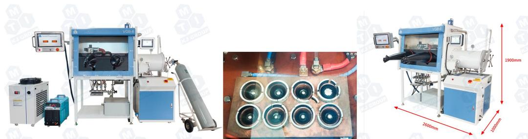
SP-MSM-VC-8 是一款自动化电弧熔炼系统，并且可以真空铸造，用于采用高通量和自动化方式进行合金探索。此款设备的特点是 8 个熔炼工位，每个熔炼工位底部都安装了独立的水冷铸造铜模。通过编辑设置，钨电极枪可以精确定位到每个熔炼工位，并且按程序依次熔炼每个样品。而且，系统在循环手套中，确保实验在洁净和无水氧环境下进行。
