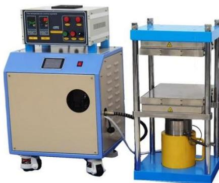
YLJ-HP300-SC 是一款高精度的大尺寸平板热压机。带有两个加热板，其温度是由两个智能控温仪来控制的，最高  $500^{\circ}\text{C}$ 。热压平板为精加工平板，并且安装有导向轨，拥有较高的平行度公差与平面度公差，特别适合脆性片状材料的热压键合实验。同时较大的平板间距，适合多块材料热压或者配套客户的定制模具。设备具体尺寸可以进行定制，多种相关型号可选。
